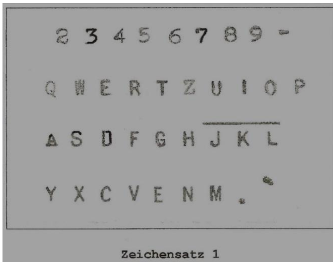
Abb. 10: Zeichensatz 1, vierreihige Schreibmaschinen- Anordnung mit 38 Großbuchstaben und Satzzeichen.
