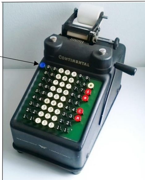
Abb. 1: Continental 8 , S/N P.45033; Druck- und Rechenwerk 8-stellig,
